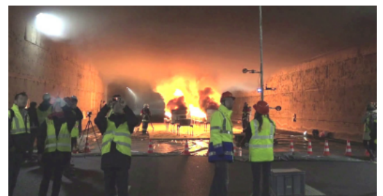
Les essais sur site permettent de visualiser l'efficacité des systèmes de désenfumage - essais incendie dans le tunnel de Nogent.
